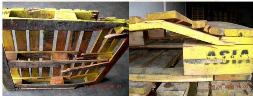
Gambar 1.3 Kerusakan Palet BER pada Papan Atas, Stringer, dan Papan Bawah
