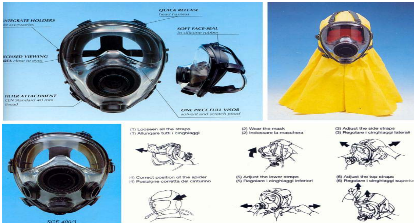
Gambar 8. 21 Bagian-Bagian Respirator dan Cara Pemakaian
