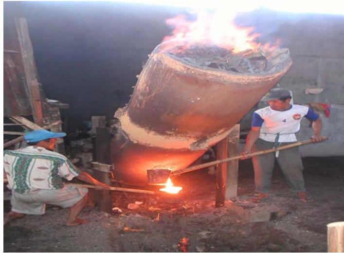
Gambar 7.2 Mengambil Cairan Logam dari Tungku
