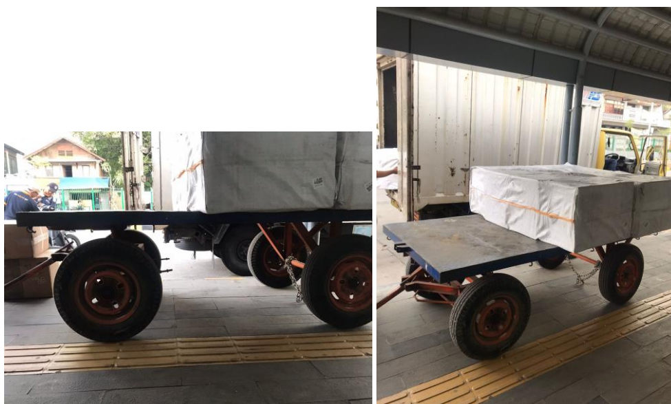
Gambar 3. 9 Tidak menggunakan stock blok
